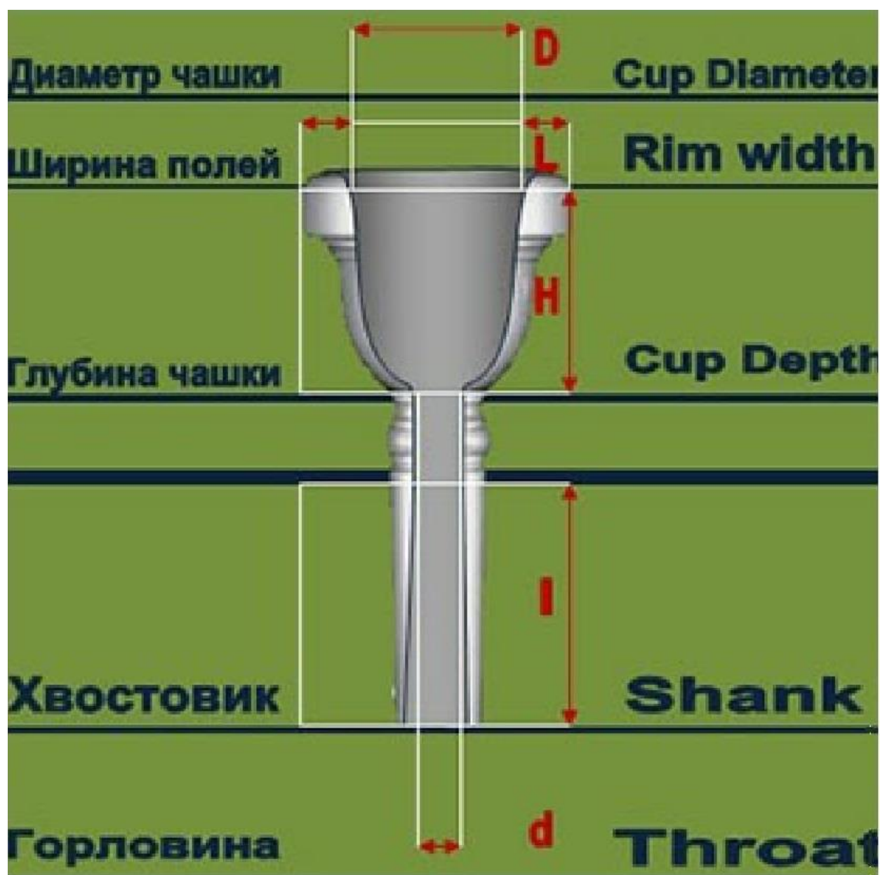
Рисунок 13. Параметры тромбового мундштука (Yeo, 2017).
